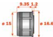
Montage avec panneaux > 16 mm:
